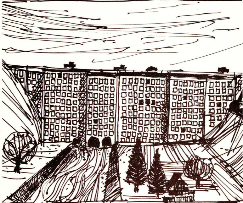
Modellaufnahme der geplanten Bauten. Die Sense kann leider vorderhand noch nicht eingelegt werden, so daß einige Löcher für ihren Durchlauf offenbleiben müssen.
