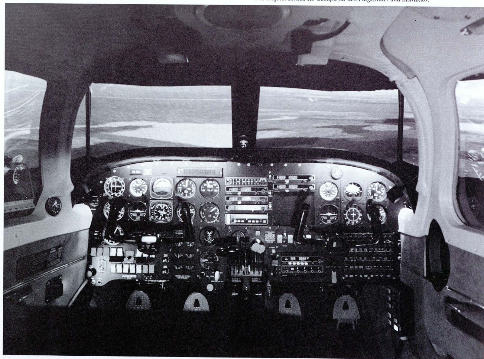
Das original Seneca-III-Cockpit für den Flugschüler und Instruktor.
