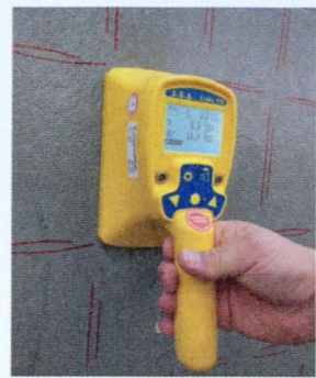
Oben: Auf radioaktive Unverträglichkeit überprüft: Splitterschutzsteine.
