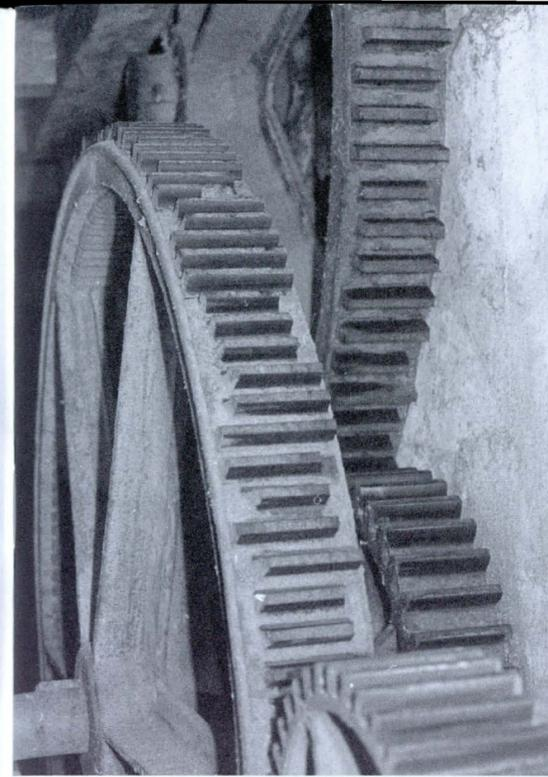
Getrieberäder mit Zähnen aus Hartholz
