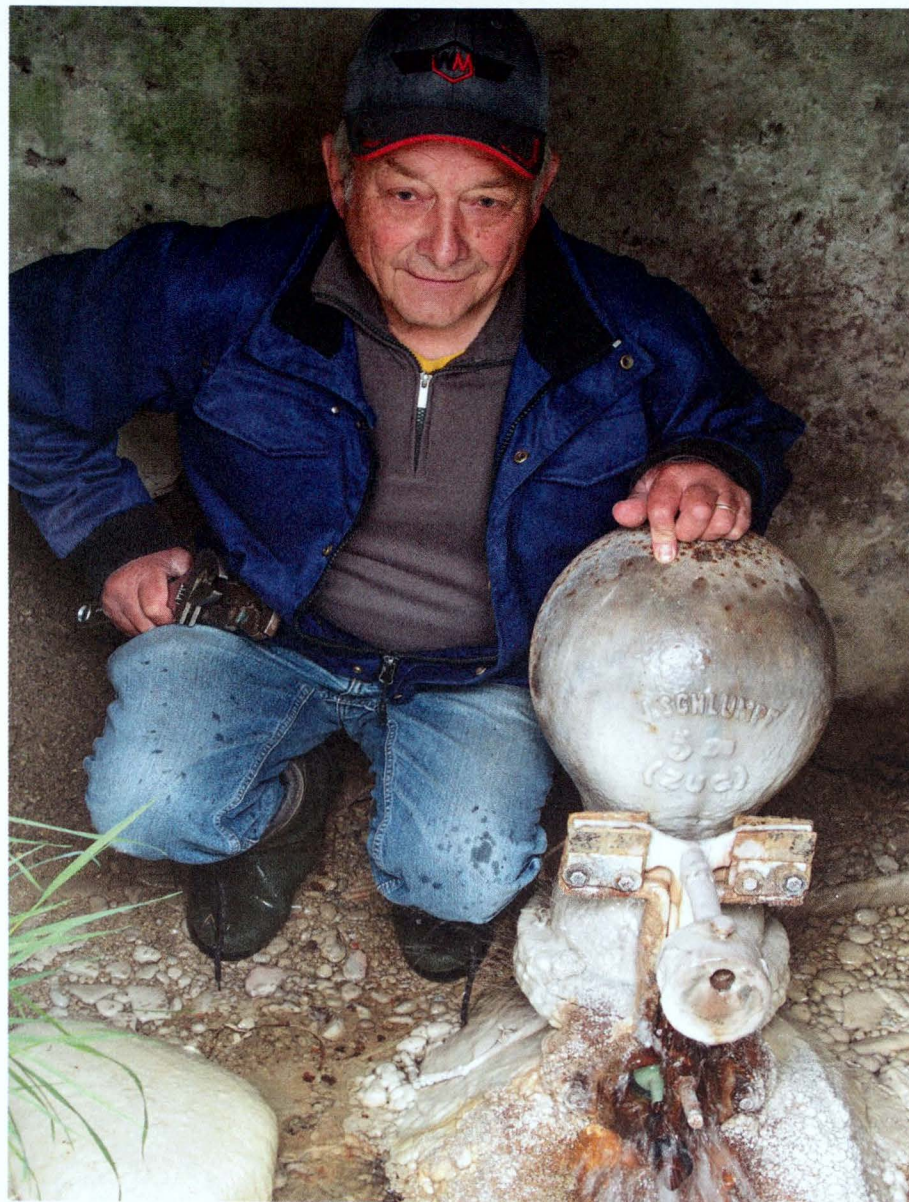
Oben links: Edgar Herren mit seinem mindestens 116 Jahre alten und immer noch einwandfrei funktionierenden hydraulischen Widder.
